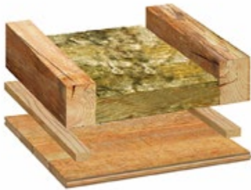
Schritt 1: Fehlende 6 cm Zwischensparrendämmung WLS 035 ergänzen
