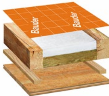
Schritt 2: Neue luftdichte Schicht aufbringen, beispielsweise BauderTEX DB
